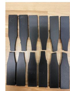
Fig. 8: Tensile Specimens
